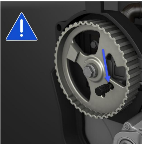
Nockenwelle und Nockenwellenrad blockiert Langloch in 4-Uhr-Position
