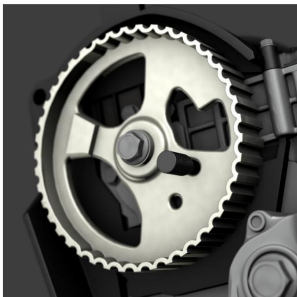
Zahnriemen / OT: Langloch in 4-Uhr-Position
