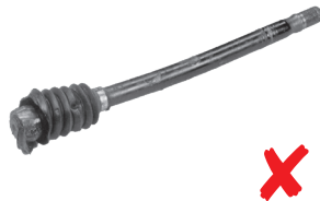
La transmisión está incompleta: falta una junta.
