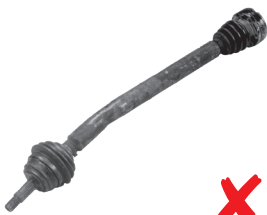
La transmisión está completa pero la barra está doblada.
