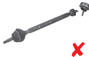
La transmisión está incompleta: se ha roto una junta.
